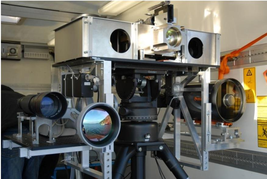
Lidar med  $1,5 \mu\text{m}$  laser kopplat till IR
