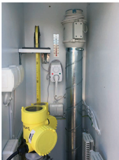
Bild: Mätstation för vattenstånd vid Kungsholmsfort samt mätutrustning inuti stationen vid Landsort Norra.
