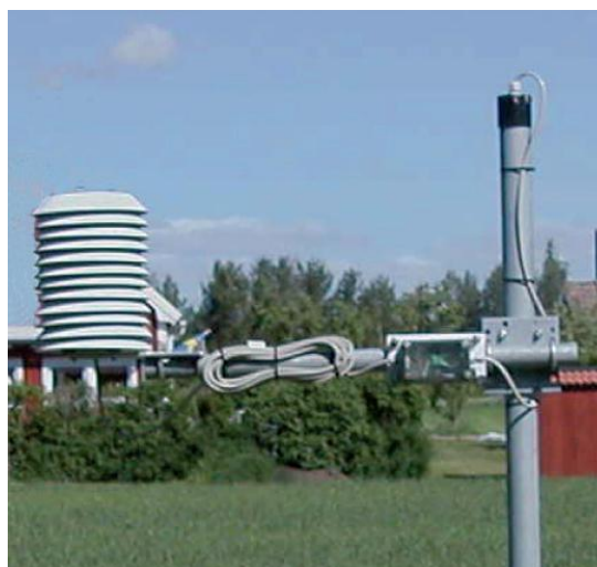
Figur 4. SMHIs automatstation. Till vänster ser vi strålnings- och nederbördsskyddet som skyddar temperatur- och fuktighetsgivarna. Foto Morgan Zinderland.
