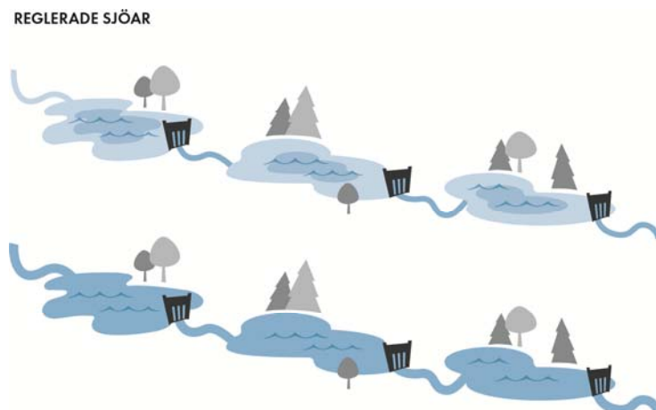
Figur 3. Bilderna illustrerar ett reglerat system där det finns möjlighet att hålla en jämnare vattenföring i vattendraget. Den övre bilden visar ett lågflödestillfälle och den nedre ett högflödestillfälle.
