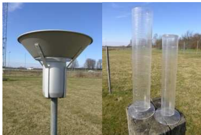
Figur 2. Dagens nederbörds kärl med vindskydd för manuell nederbördsmätning till vänster och mätglas för att mäta mängden nederbörd till höger.
