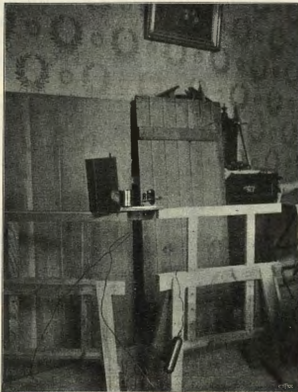
Fig. 31. Tryckluftspegel av primitiv konstruktion vid Strömsbro i Disan (67—157).
