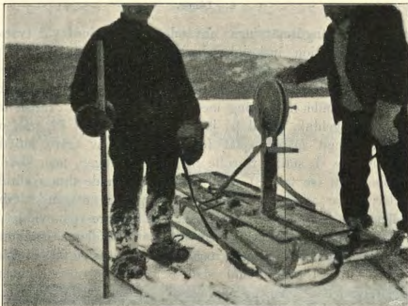
Fig. 65. Kälke med lodningsmaterial på Björkvattnet (Umeälv's flodområde).
