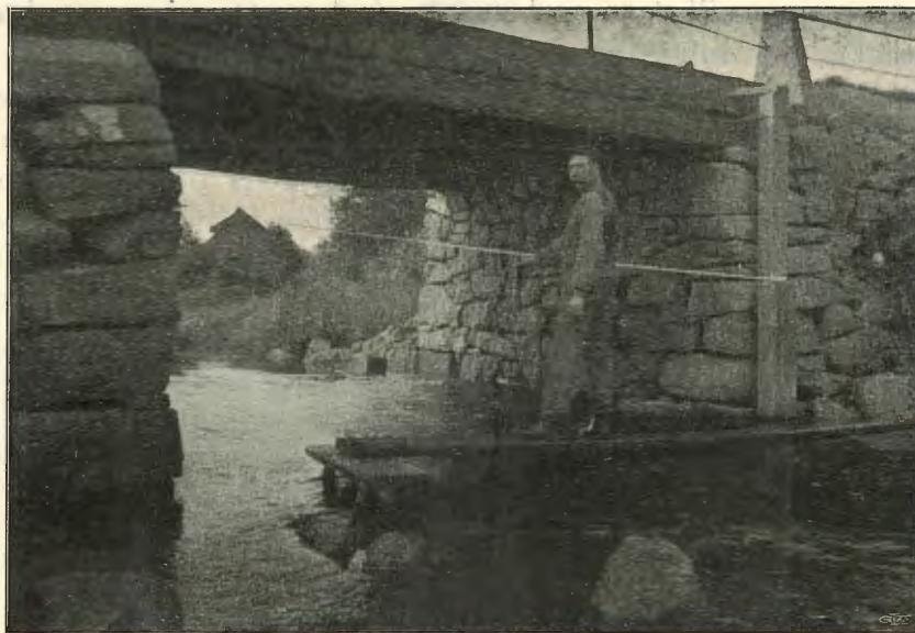
Fig. 36. Mätning med flygel 37 från spång vid Strömsbro i Disan (67—157).
