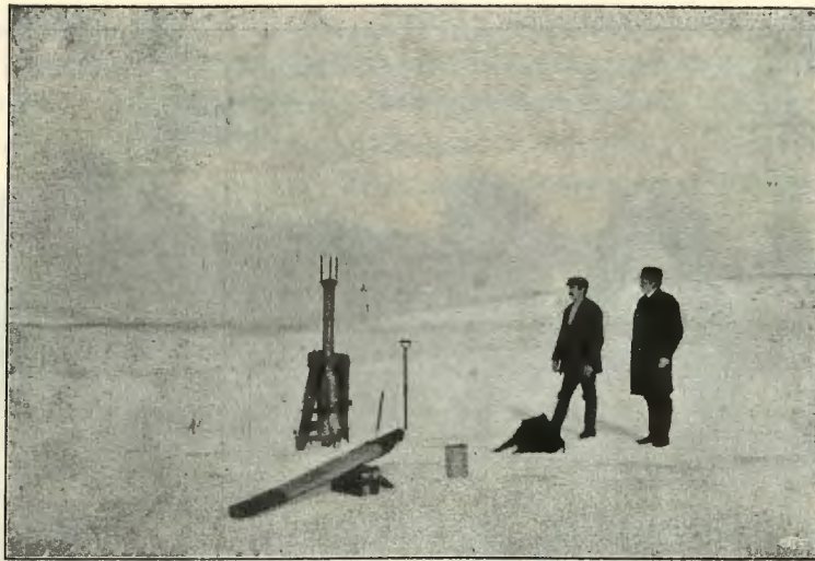
Fig. 30. Självregistrerande H-B-pegel vid Stommen i Hornborgasjön (108—494). Skyddshuv borttagen. På isen H-B-teodelit med avvägningsstänger i fodral.
