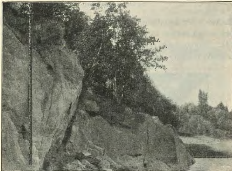
Fig. 10. Äldre järnpegel (målade skenfot) vid Ragunda i Indalsälven (40—89), 5 m långd, sicksackindelning i dm och 2- cm med m- och dm-siffror.
